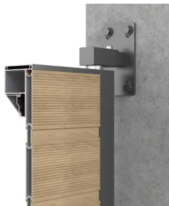
Λεπτομερείς προβολές των προφίλ του φύλλου και του αυλακωτού, μαζί με το προφίλ του άξονα περιστροφής και το PIN INOX 316 ικανό να αντέξει 250 κιλά το καθένα. Η μέγιστη διάσταση φύλλου είναι κοντά στα 4m 2 , με μέγιστο φορτίο ανέμου 2KPa.
