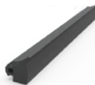
ΛΑΣΤΙΧΟ ΑΝΤΙΣΤΗΡΙΑΣ COUNTER-BALANCE GASKET Κωδ./Code F85-477 (5.5.4, 6.6.4, 8.8.4) Υλ. / Material PVC Μήκος/Length 100 m Σκληρότητα/Hardness 100 shore
