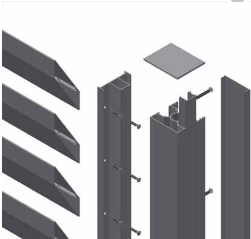
Συνδεσμολογία κολώνας SD-8005AN με SD-8006L προφίλ. Column SD-8005AN Assembling with SD-8006L profile
