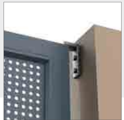
Εξωτερικός ανοξείδωτος μεντεσές στήριξης με δυνατότητα ρύθμισης +/-2mm
